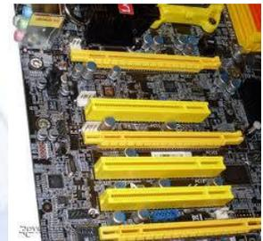
Рядом с северным мостом, перпендикулярно слотам оперативной памяти, расположен слот или разъём для видеокарты (PCI – Express). Как и слоты оперативной памяти, PCI – E посредством шин связаны с северным мостом, а через него с центральным процессором.
