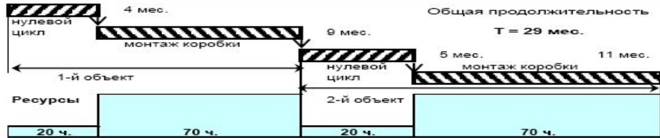
А. Последовательное выполнение работ
