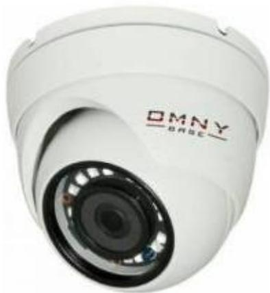
IP камера OMNY BASE miniDome2E v1.1 миникупольная 2Мп (1920×1080) 25к/с, 2.8мм, F1.8, 802.3af A/B, 12±1В DC, ИК до 25м, встр.микр, DWDR, без microSD/USB
