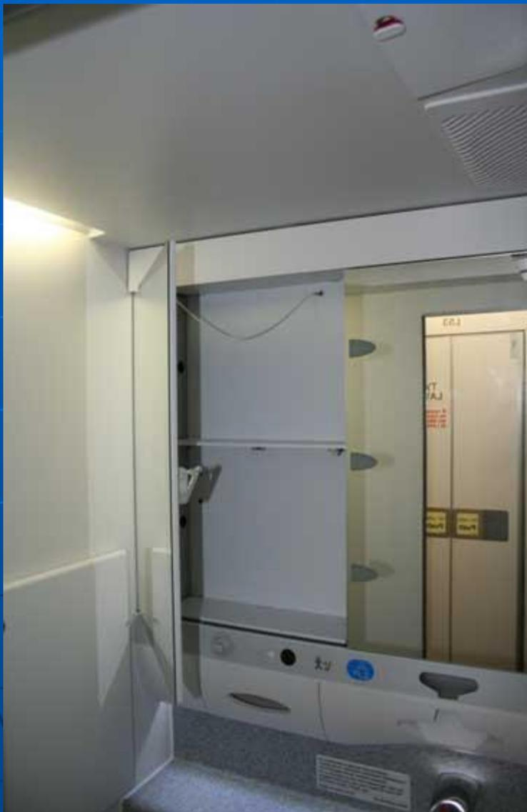
При экипировке туалетов необходимо контролировать размещение ПКЭСО в нишах за зеркалами, *не допуская выхода за габариты полок ниш*, во избежание поломки зеркальных створок. Для того, чтобы открыть створку, необходимо нажать на нижний край створки слева или справа. Места нажатия обозначены графическими наклейками в форме стрелки.
