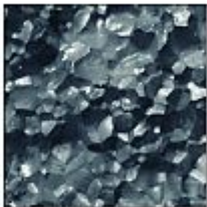
Некристаллитный хрупкий излом X5
