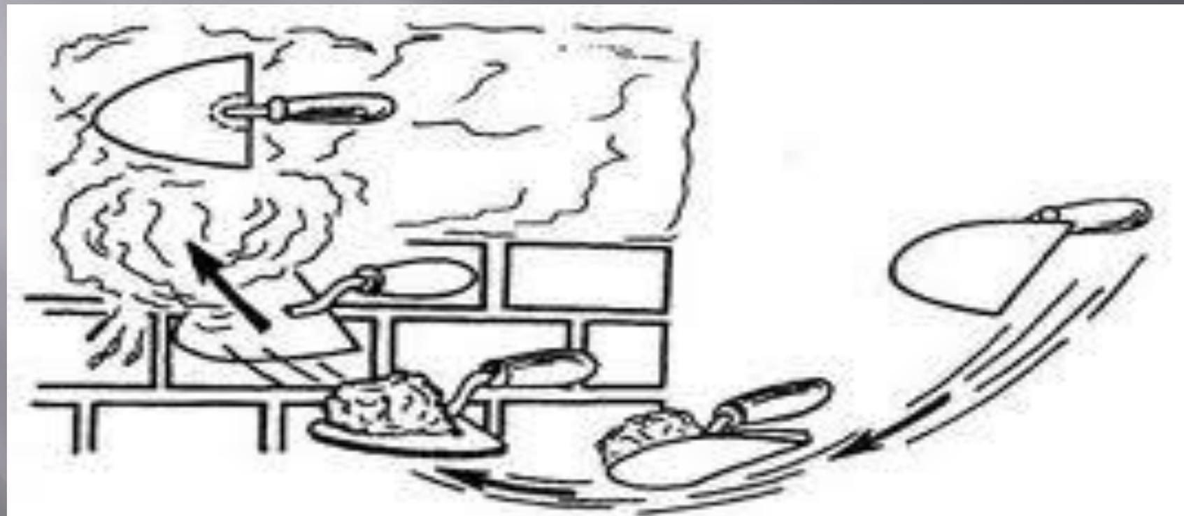
**Рис. 22. Нанесение раствора на оштукатуриваемую поверхность**
