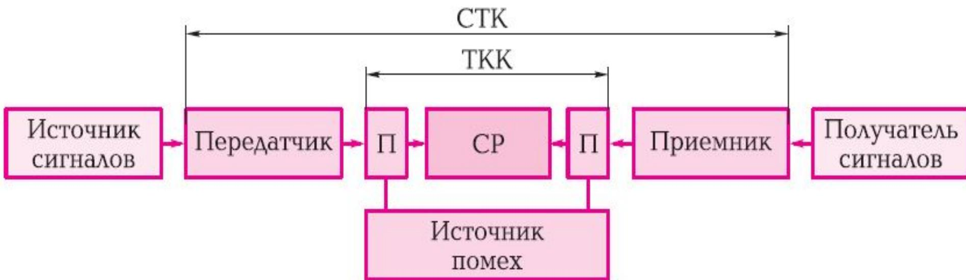
Структурная схема системы телекоммуникации (СТК) служит для передачи на расстояние сообщений между двумя абонентами по телекоммуникационному каналу (ТКК).
