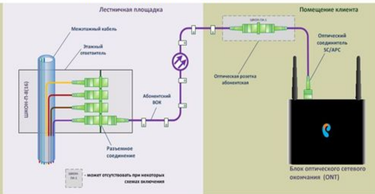
Организация абонентского отвода с этажной распределительной коробкой
