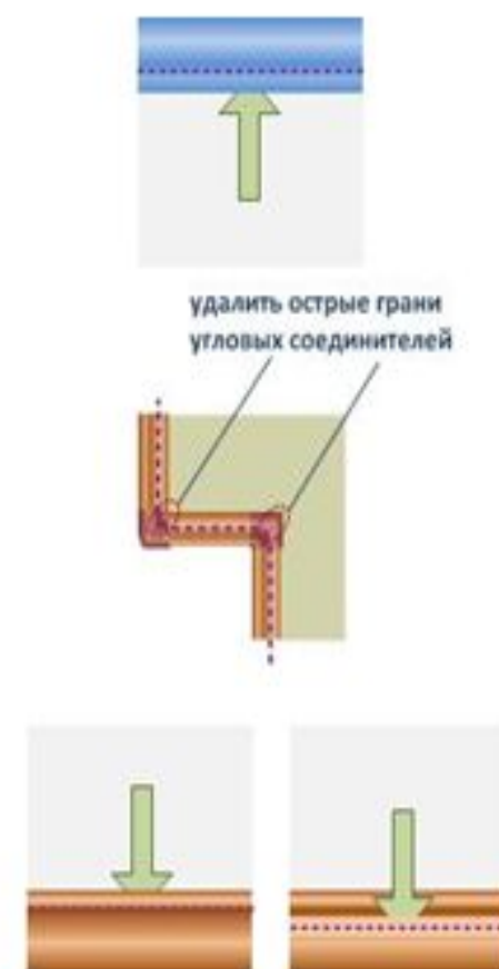
Укладка ВОК в плинтусы
