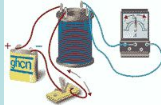
3) Зміни сили струму в колі першої котушки за допомогою реостата або ключа
