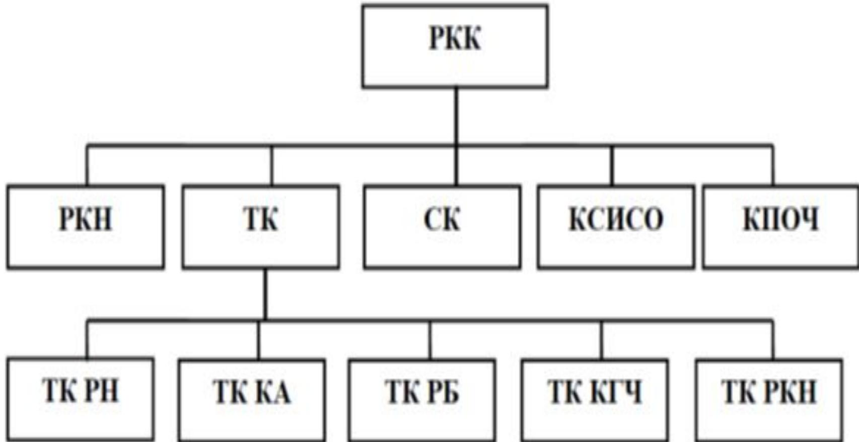
КСИСО предназначен для обеспечения контроля параметров РКН и ее составных частей при подготовке на ТК и СК, а также при полете РКН на участке выведения, обработки, документирования и распределения информации между потребителями.
