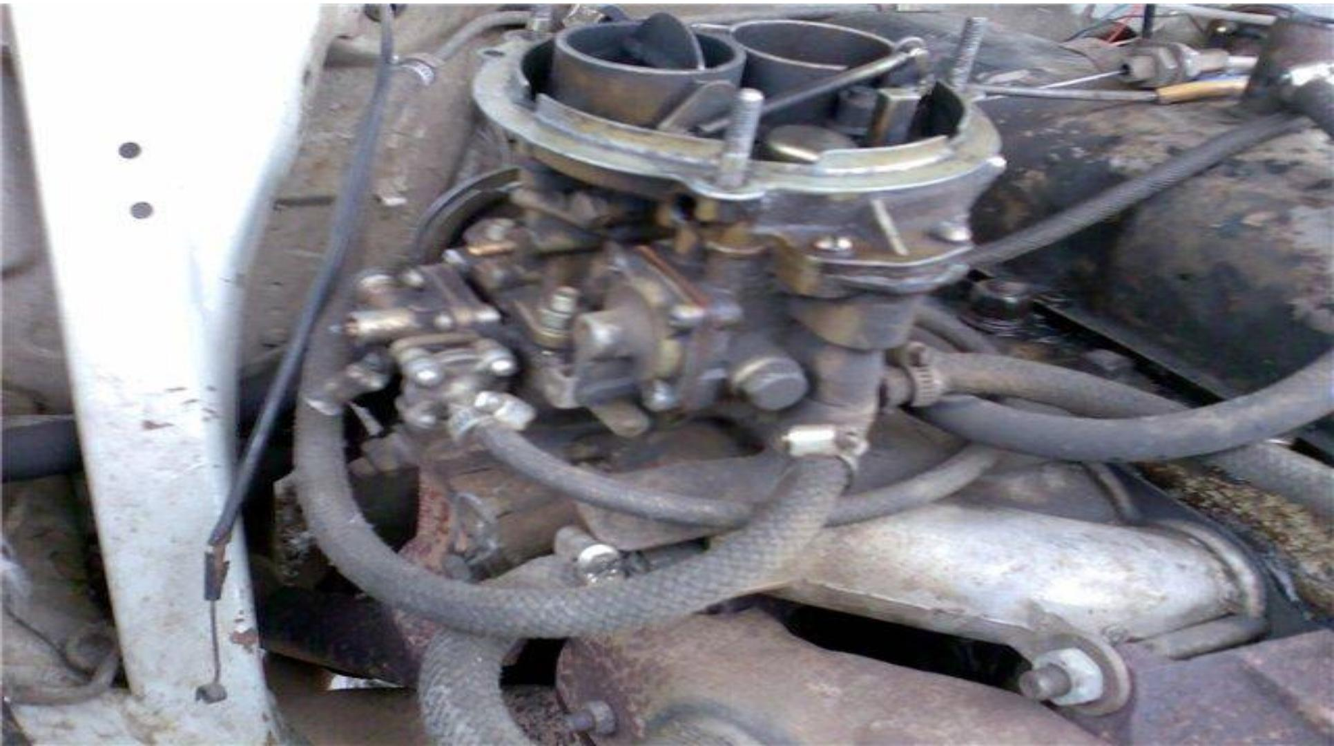
Наиболее полно смесеобразование обеспечивается при температуре 45...65°C
