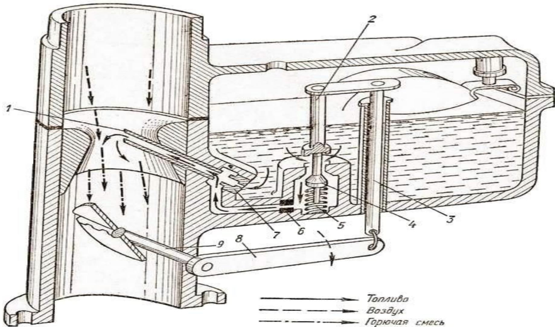
С повышением скорости перемещением воздуха в смесительной камере тонкость распыления бензина увеличивается, а следовательно, увеличивается и скорость его испарения.
