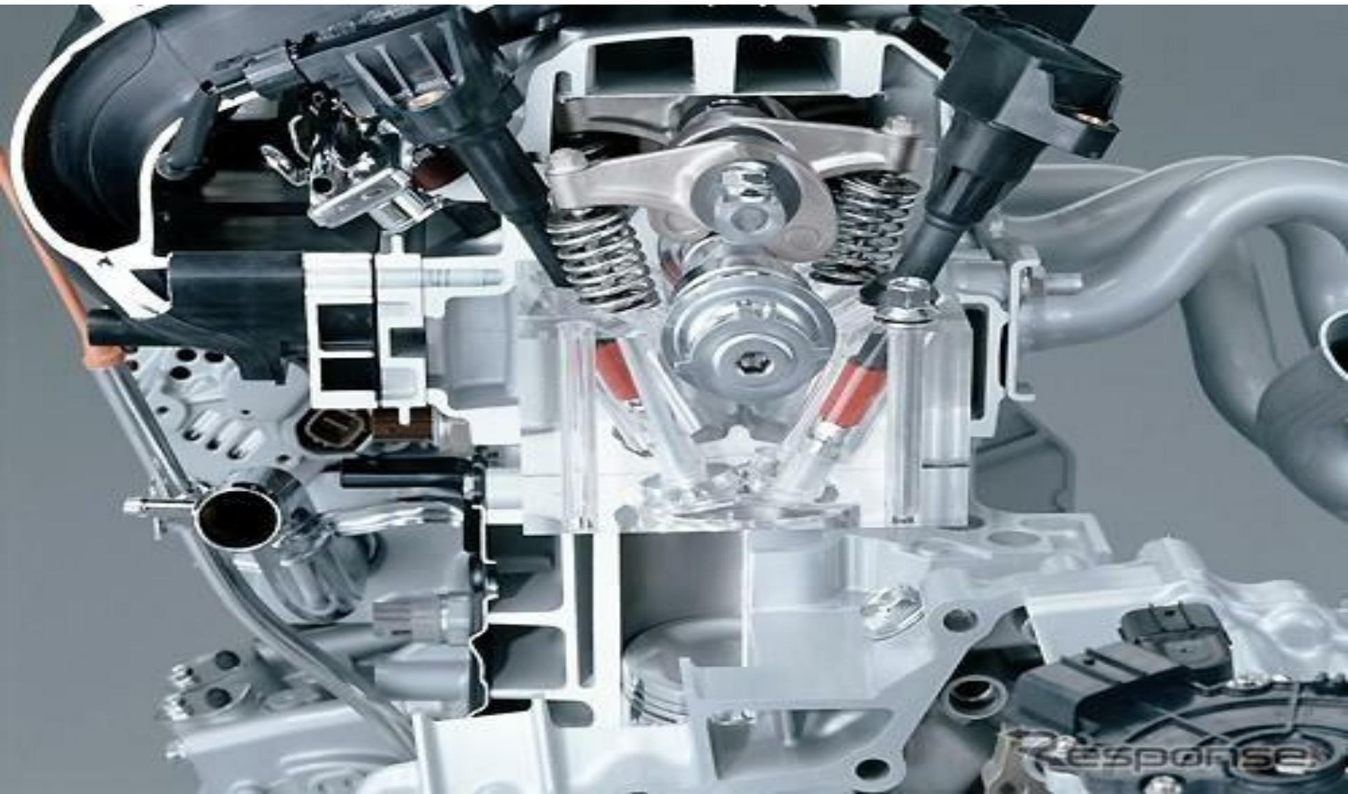
**ТАКТ ВЫПУСК. НАЧАЛО ТАКТА** Во время такта выпуска «выпускной» клапан открыт а «впускной» закрыт. Поршень движется от НМТ к ВМТ, выпуск отработавших газов происходит вытеснением поршнем — *принудительный выпуск*. Выпуск отработавших газов проходит с скоростью 800 м\с. Давление составляет 0.11 ...0.12 МПа, а температура бензинового ДВС 750... 900° С.
