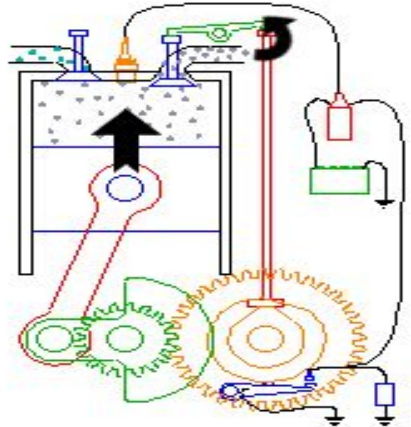
**ТАКТ ВЫПУСК. КОНЕЦ ТАКТА.** В конце такта выпуска поршень движется от НМТ к ВМТ, «выпускной» клапан открыт, «впускной» клапан открывается за  $10 - 30^\circ$  С ПКВ до прихода в ВМТ. При этом давление в цилиндре двигателя составляет  $0,11 \dots 0,12$  МПа., а температура.
