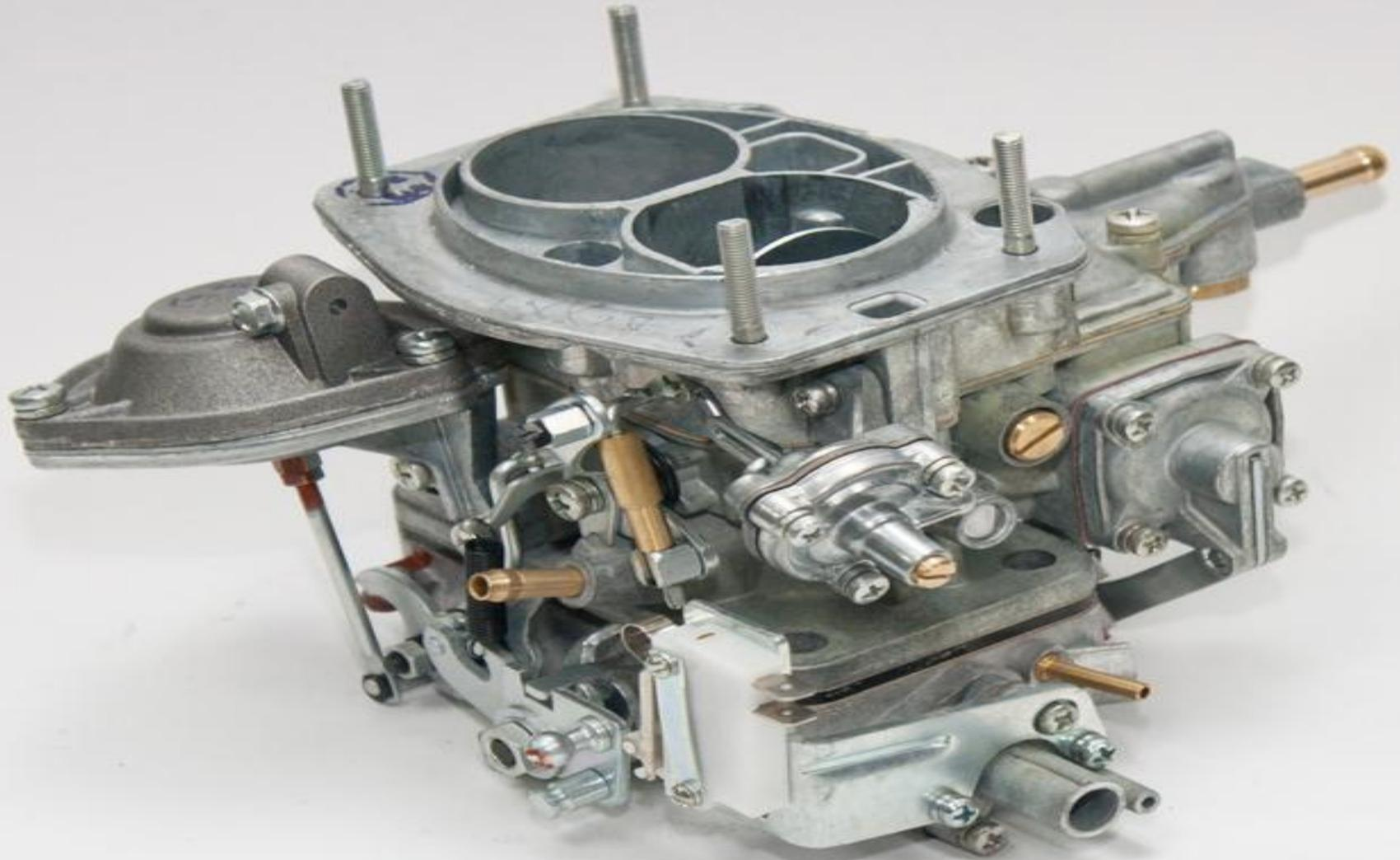
**Основным назначением карбюратора является дозирование подачи, бензина для любого из возможных режимов работы двигателя.**
