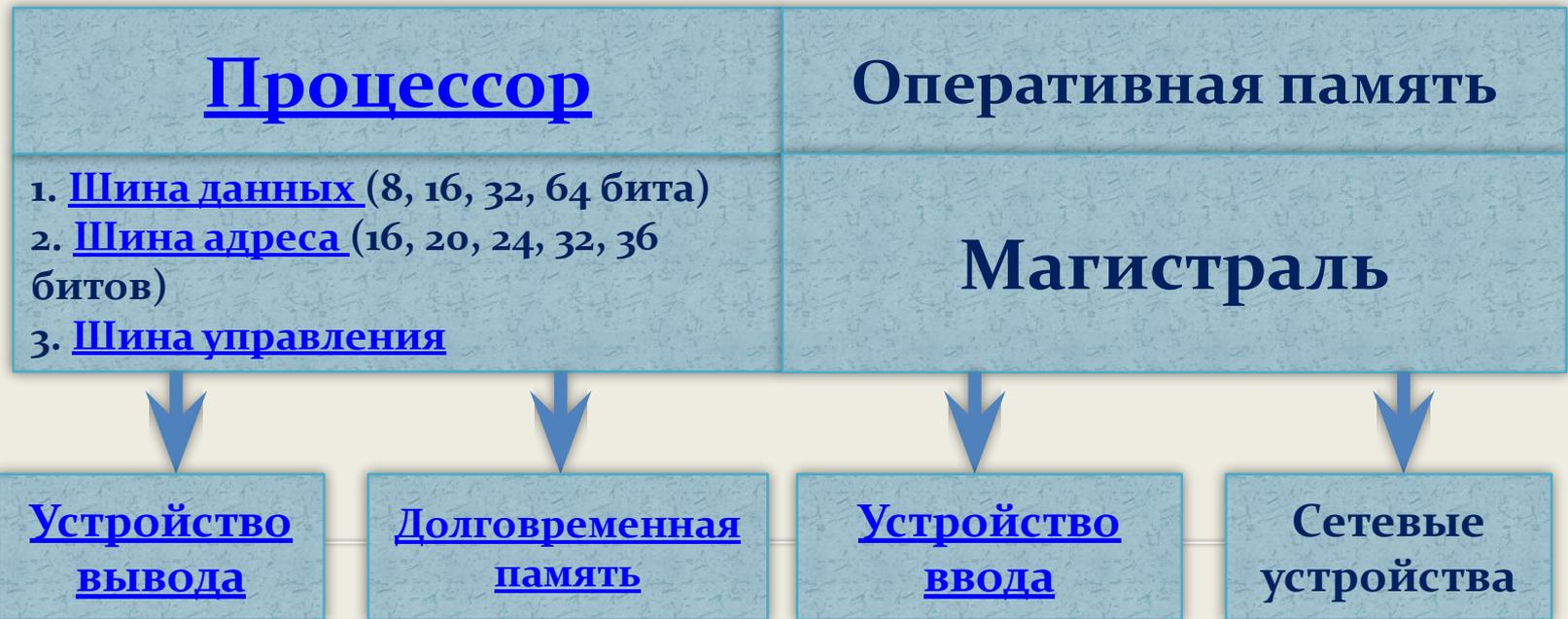
Модульный принцип позволяет самостоятельно комплектовать компьютер. К магистрали подключается процессор, оперативная память, а также периферийные устройства.
