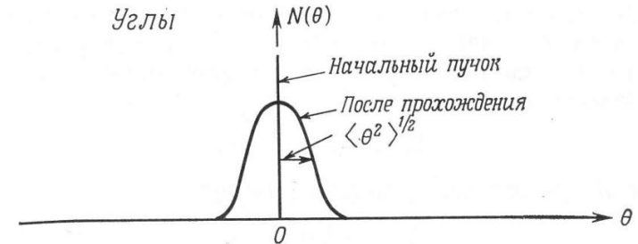
Фиг. 3.2. Распределения по энергиям и углам частиц в пучке тяжелых заряженных частиц до и после прохождения ими поглощающего слоя.
