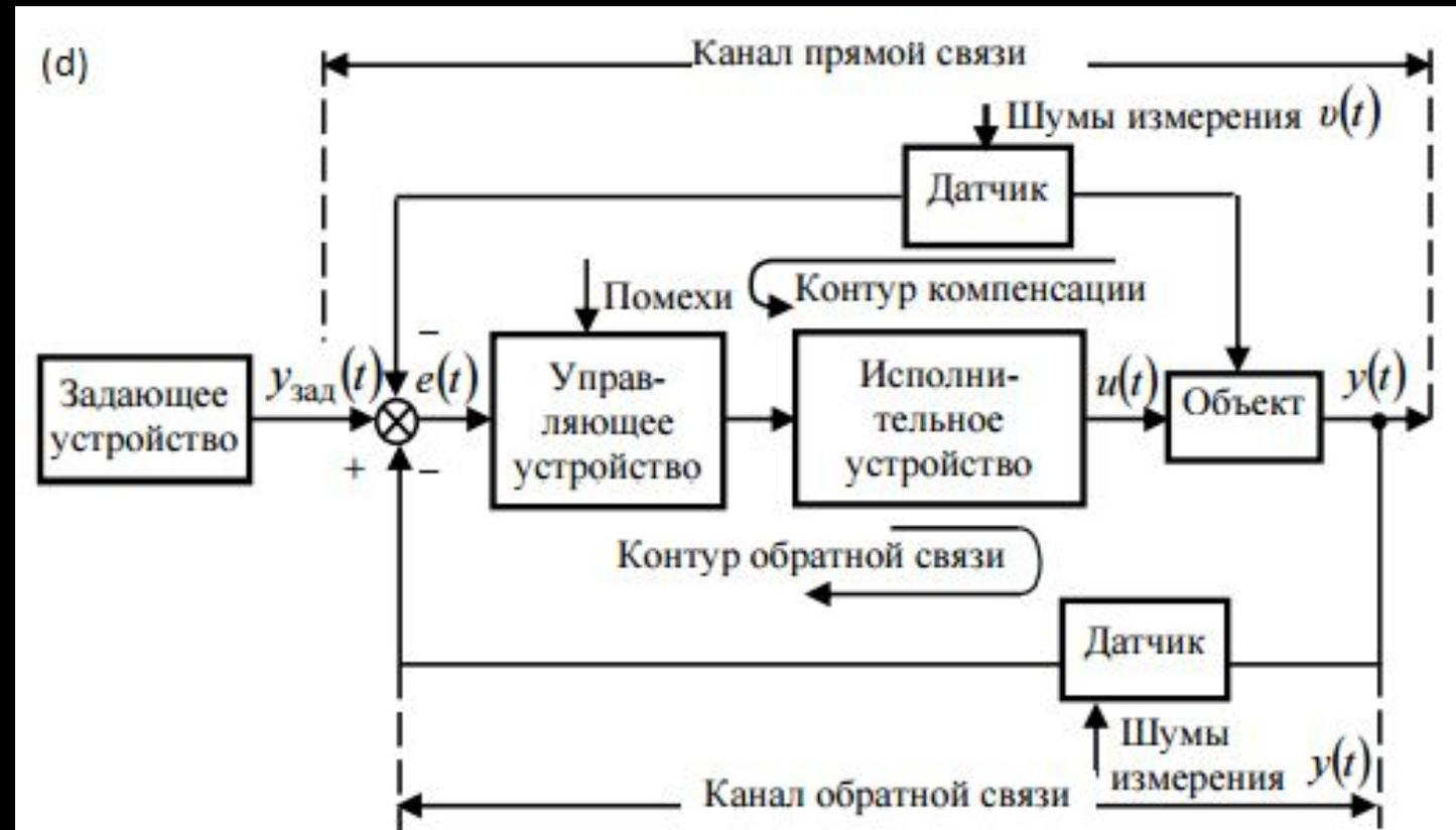
В зависимости от характера изменения  $y(t)_{\text{зад}}$  выделяют три основных типа САУ:
