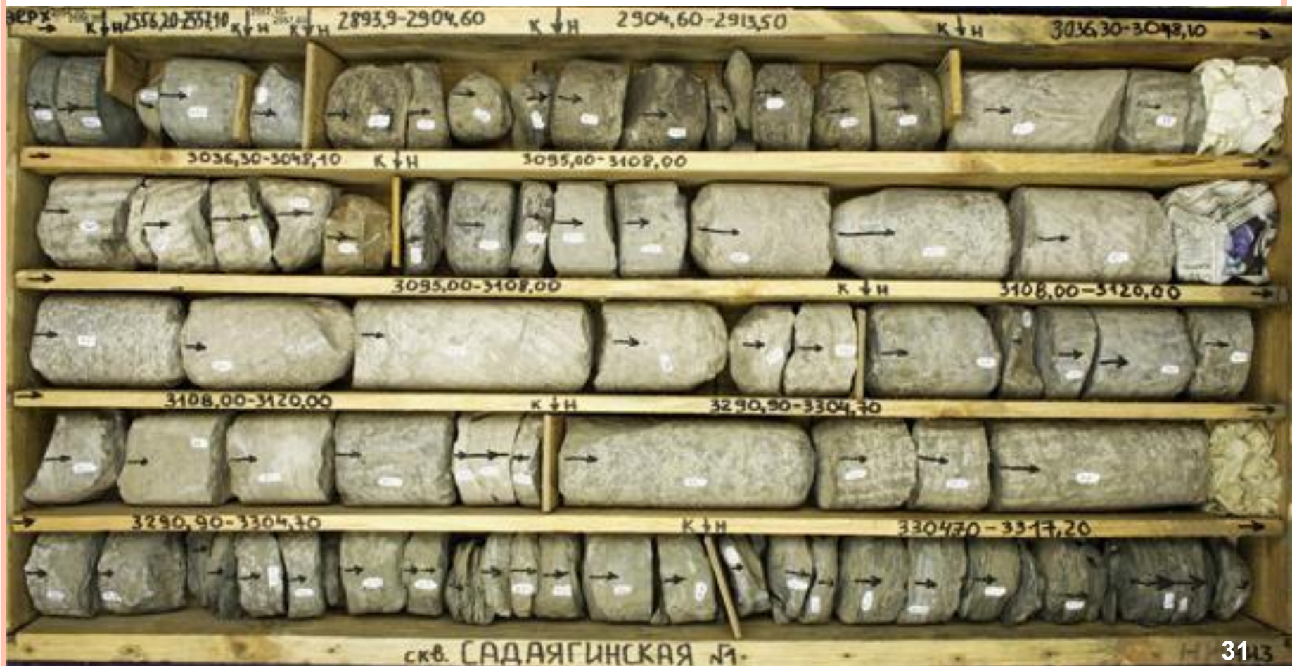
Пример полевой документации керна скважины
