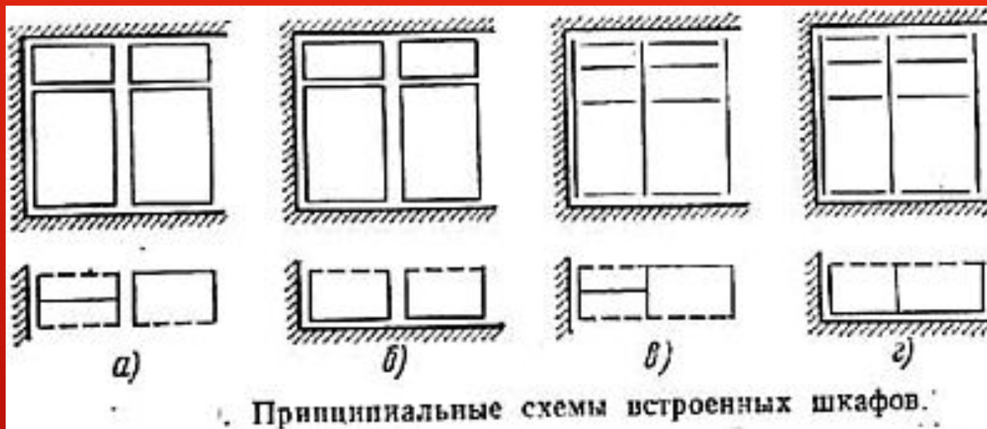
Рис. Схемы встроенных шкафов: перегородок (а) и пристенных (б), блокируемых из готовых секций; перегородок (в) и пристенных (г) универсально-сборных шкафов
