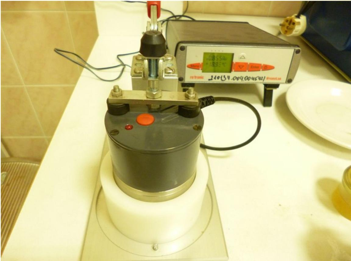
Измерение активности воды в лаборатории
