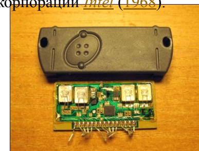
Гибридная микросборка STK403-090, извлечённая из корпуса
