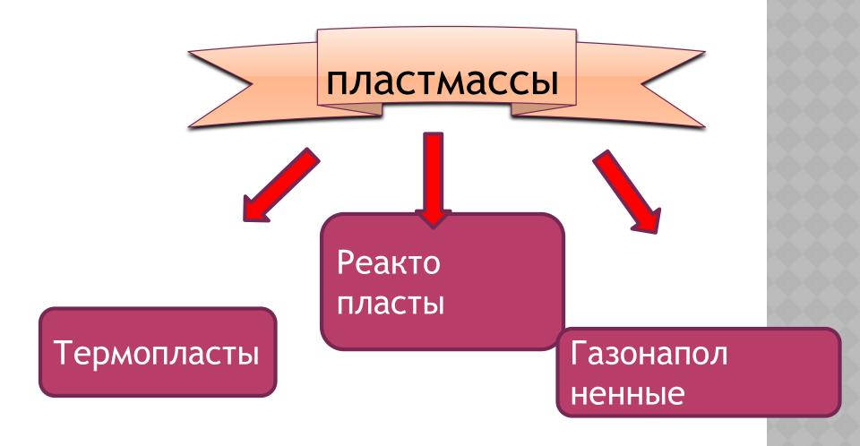
Термопласты (термопластичные пластмассы) - при нагреве расплавляются, а при охлаждении возвращаются в исходное состояние.
