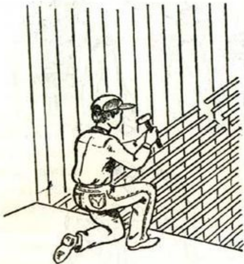
Рис. 161. Набивка драни: а — техника набивки; б — набитая дрань
