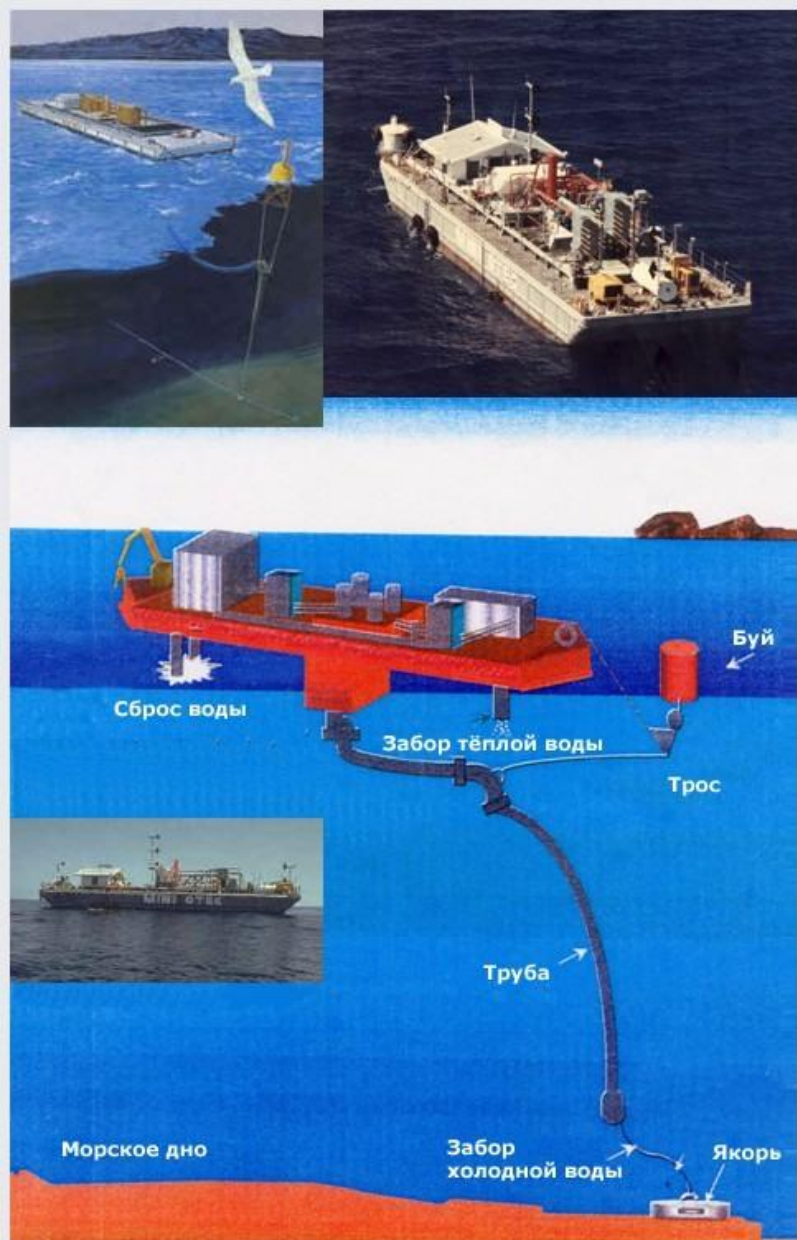
В качестве рабочей жидкости установка Mini-OTEC использовала аммиак, а холодная вода со дна моря (с глубин порядка 700-900 метров) перекачивалась на баржу по толстой полиэтиленовой трубе (иллюстрации с сайтов makai.com, otecnews.org, wastedenergy.net).
