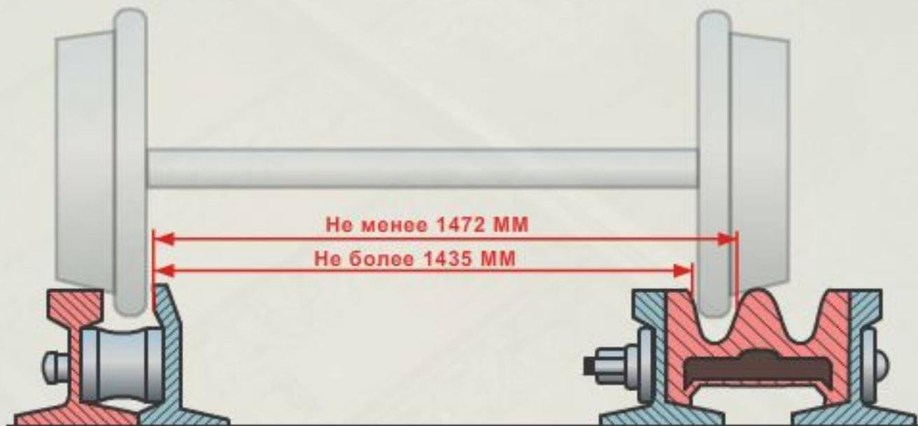
ПРИ НЕСОБЛЮДЕНИИ УСТАНОВЛЕННЫХ РАССТОЯНИЙ МЕЖДУ РАБОЧЕЙ ГРАНЬЮ ГОЛОВКИ КОНТРЕЛЬСА И РАБОЧЕЙ ГРАНЬЮ СЕРДЕЧНИКА КРЕСТОВИНЫ МОЖЕТ ПРОИЗОЙТИ УДАР ГРЕБНЯ КОЛЕСА В СЕРДЕЧНИК.
