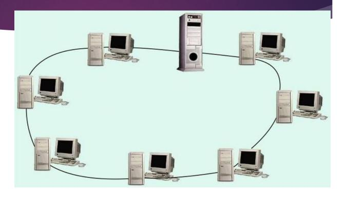
Файл-сервер и рабочие станции соединены кабелем в кольцо. Сообщения рабочей станции могут проходить через несколько других рабочих станций до того, как они достигнут файл-сервера.
