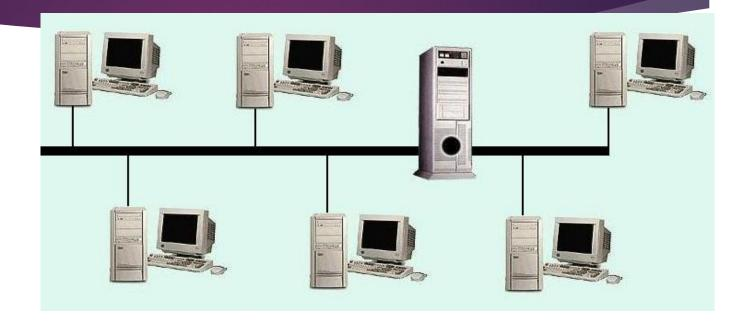
Рабочие станции и файл-сервер подключаются к центральному кабелю, называемому шиной.
