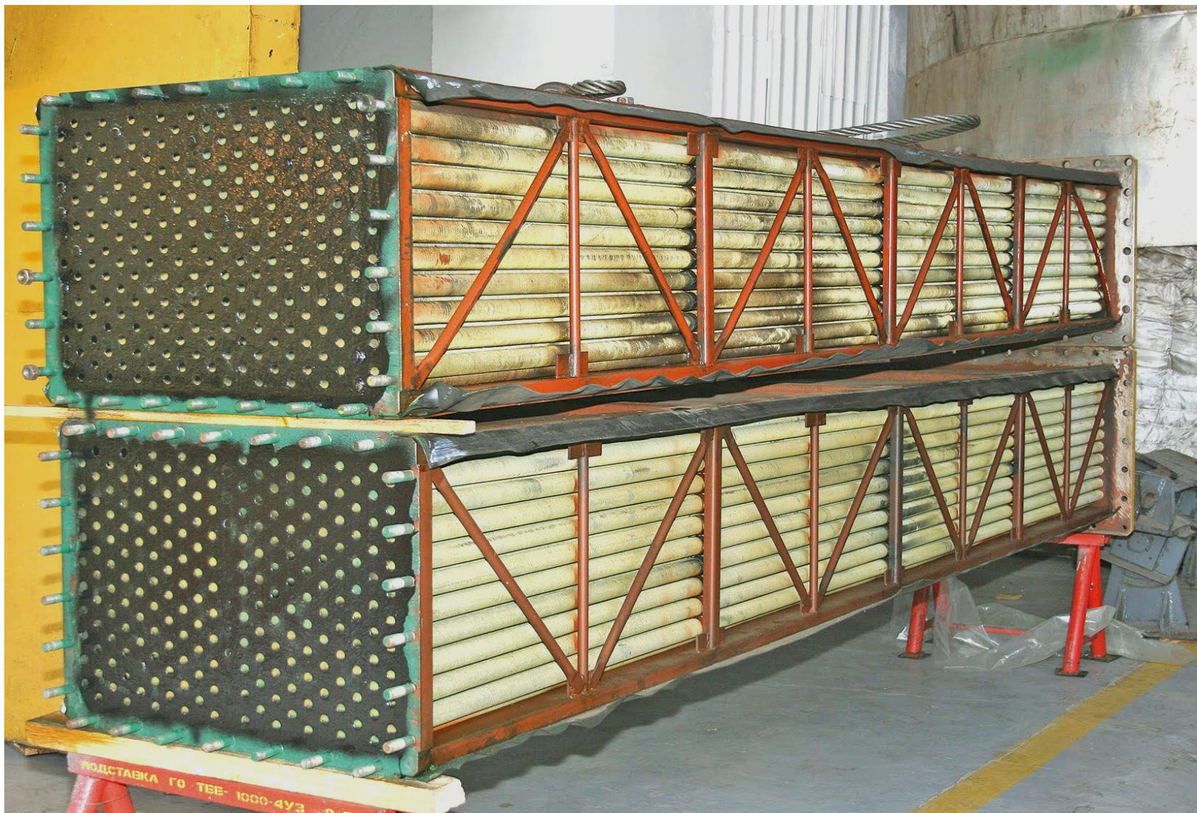
Рис. 5.5. Внешний вид оборудования трубных досок .
