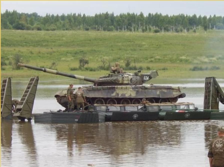
Для переправы через водные преграды танков, самоходных орудий и другой гусеничной техники весом **до 52 тонн** имеются гусеничные самоходные паромы ГСП. Эти машины на марше следуют в танковой колонне и решают задачу переправы тяжелой техники. Скорость на плаву 10км/ час. **Танк, находящийся на пароме, может вести огонь.** Расчет парома ГСП составлял 10 человек, грузоподъемность ГСП – 52 тонны при запасе
