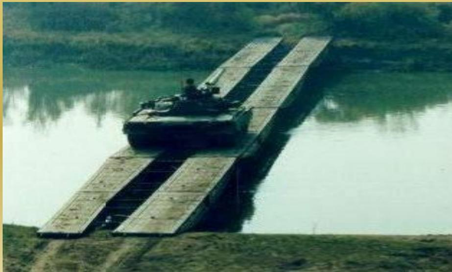
Тяжелый механизированный мост ТММ-3 предназначен для устройства мостовых переходов через препятствия **шириной до 40 м** и **глубиной до 3 м** с целью пропуска через них колесных и гусеничных нагрузок весом **до 60 т**. Комплект моста состоит из **четырёх** мостоукладчиков на шасси автомобиля КрАЗ-255Б, несущих на себе мостовые блоки с опорами.
