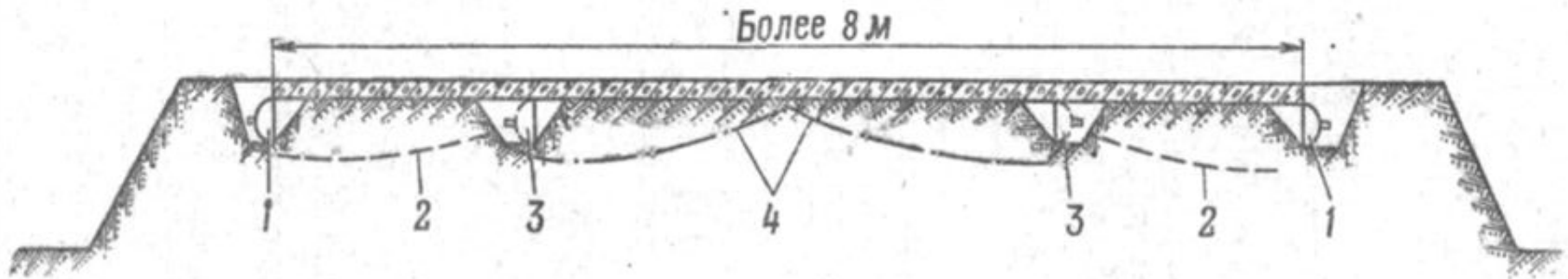
Рис. 187. Разрушение кумулятивными зарядами покрытия дорог шириной более 8 м:
