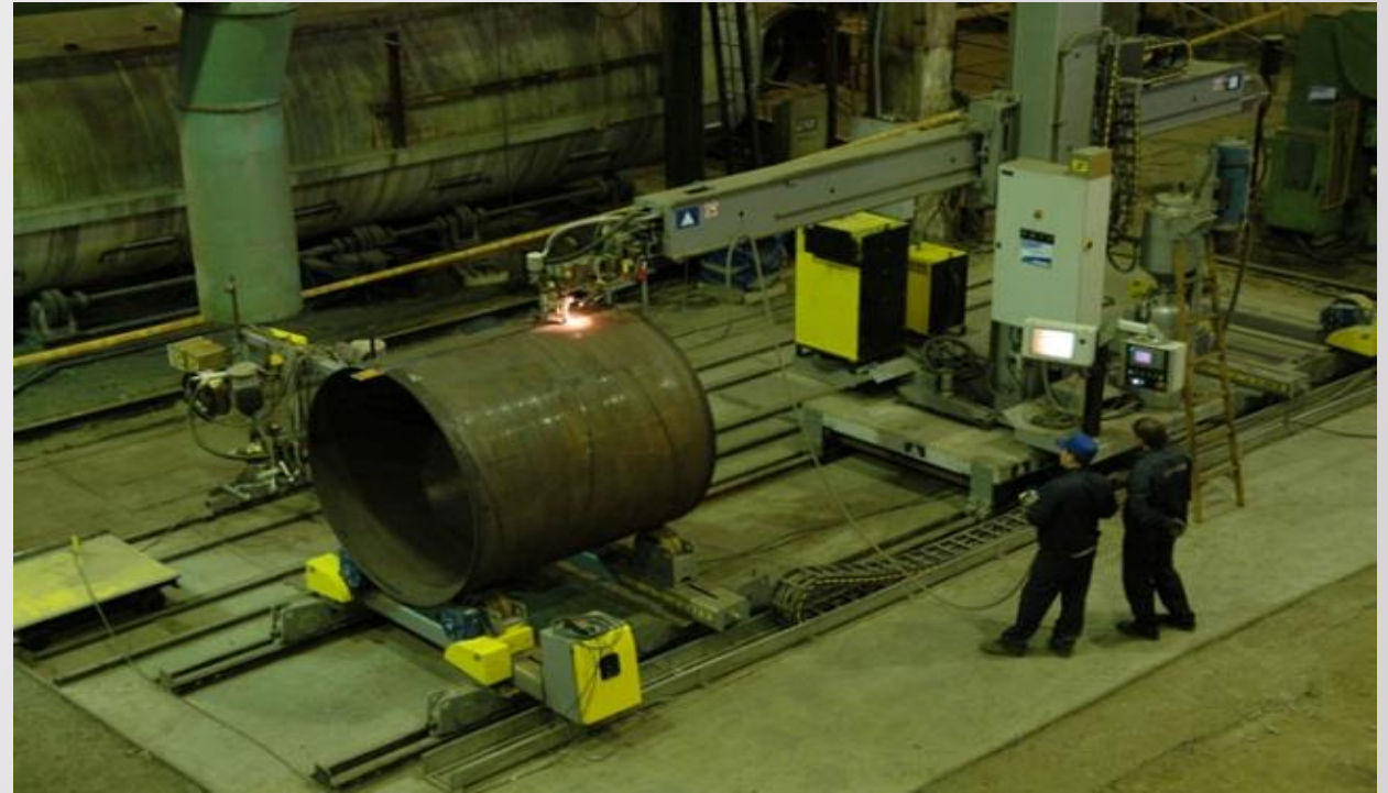
Сварка продольного стыка обечайки
