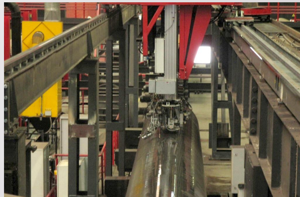
Установка неразрушающего контроля сварного шва, околошовной зоны, концов и тела труб большого диаметра
