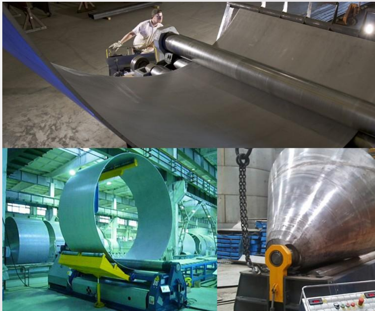
Вальцовка обечаек в производственных условиях
