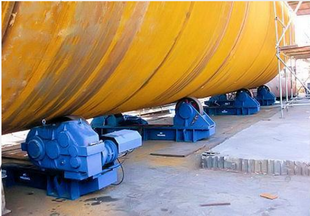
Сварочный вращатель для сборки установок на строительной площадке
