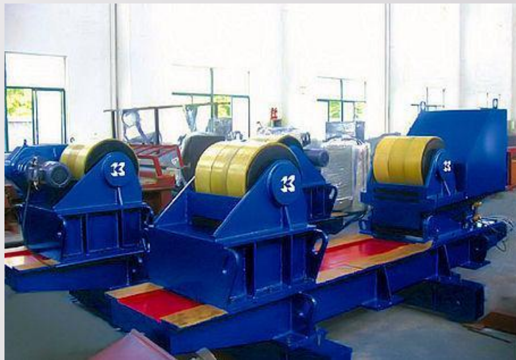
Переставные сварочные роликовые вращатели с широкими полиуретановыми роликами
