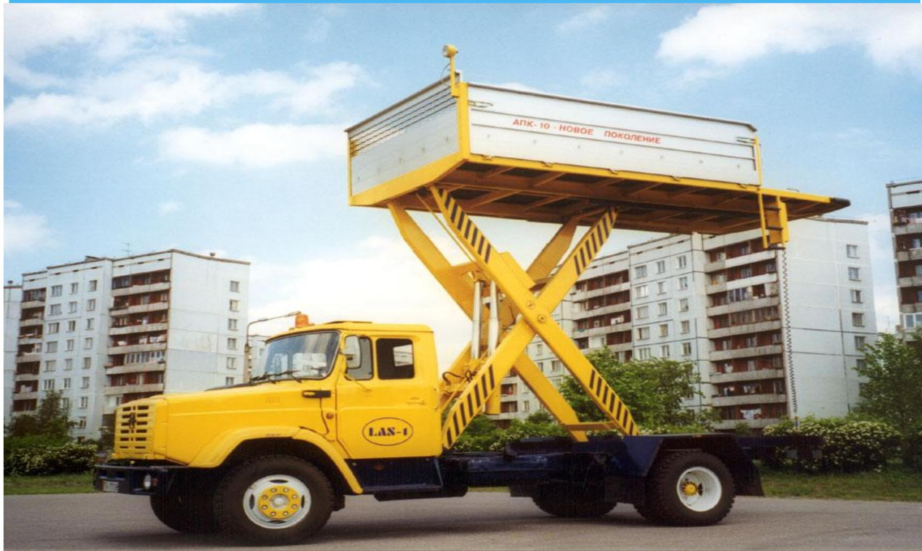
Предназначен для погрузки в самолёт и выгрузки из него багажа, почты, разнообразных штучных грузов.
