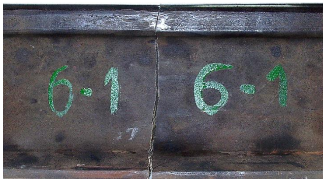
Общий вид излома от продольного расслоения
