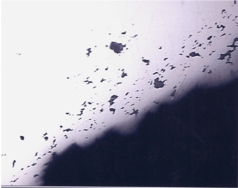
Микроструктура (Силикаты в зоне излома \times 100 )
