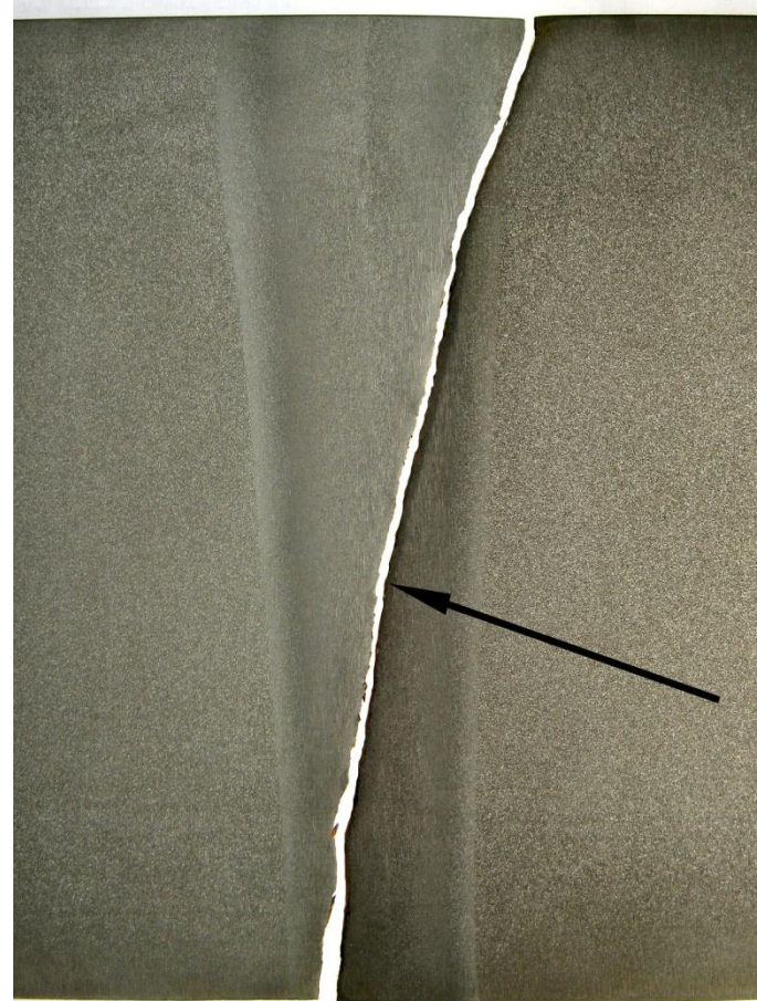
Вид излома на макротемплете (стрелкой указано место расположения дефекта)
