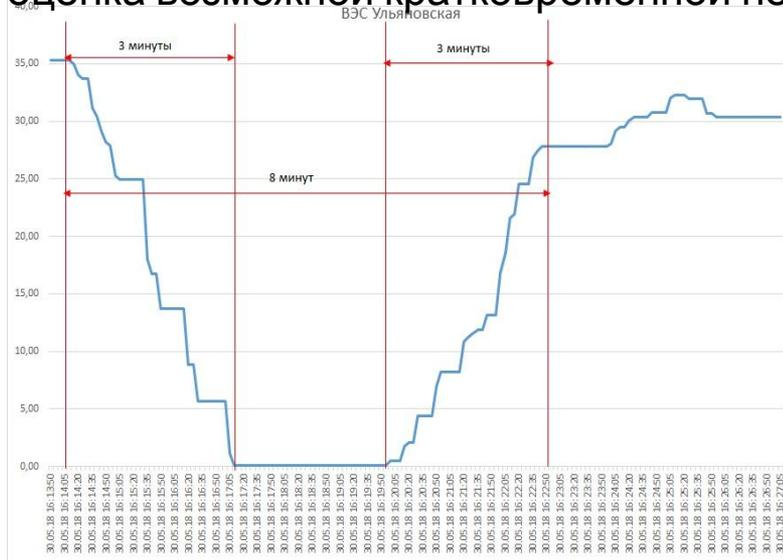
Коэффициент сброса нагрузки ВЭС может составлять до 100% за 3 минуты
