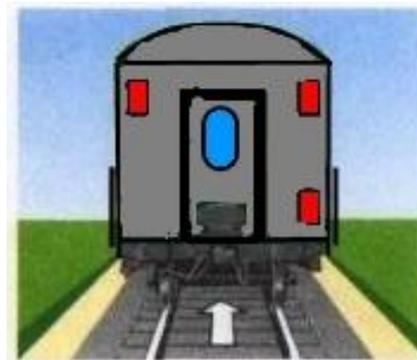
Проводник последнего пассажирского вагона, ограждающий остановившийся поезд, должен привести в действие ручной тормоз, уложить на расстоянии **800 м** от хвоста поезда петарды, после чего отойти от места уложенных петард обратно к поезду на **20 м** и показывать ручной красный сигнал в сторону перегона.
