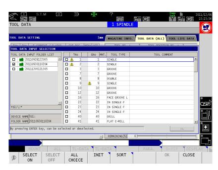
После выбора папки с данными, OSP сканирует эти файлы автоматическиthese, а затем создает список инструмента.
