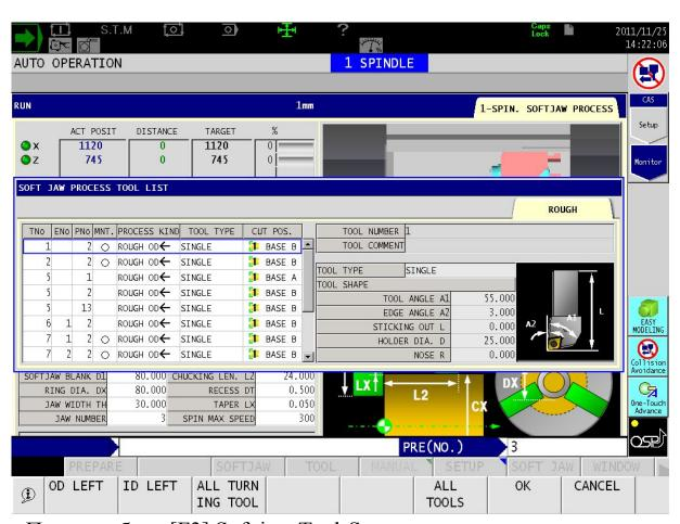
После выбора [F3] Soft jaw Tool-Set, на дисплее появляется список инструмента. Выберите подходящий инструмент и нажмите "ОК", такая же процедура для чистового точения.
