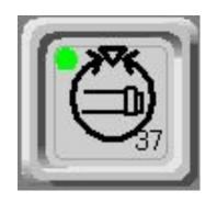
[Ориентация шпинделя] возможна по нажатию кнопки.
