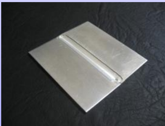
Образцы сплава АМГ6 толщиной 4 мм сваренные перемешивающей сваркой трением. Слева с лицевой стороны, справа с изнаночной
