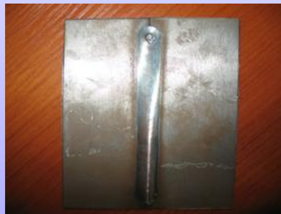
Образцы сплава АМГ6 толщиной 4 мм сваренные перемешивающей сваркой трением. Слева с лицевой стороны, справа с изнаночной
