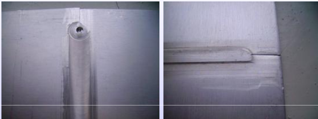
Образцы сплава АМГ6 толщиной 4 мм сваренные перемешивающей сваркой трением. Слева с лицевой стороны, справа с изнаночной
