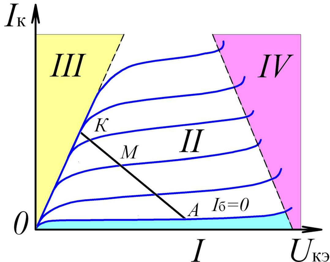
В точке  $A$  тр-тор закрыт (режим отсечки), КП находится под обратным, а ЭП – под прямым напряжением; в точке  $K$  тр-р находится в открытом состоянии (режим насыщения), КП и ЭП смещены **в прямом направлении**.
