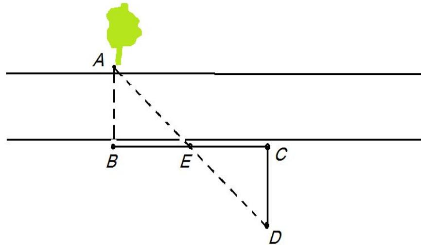
*Замер ширины реки при помощи построения равных треугольников*
