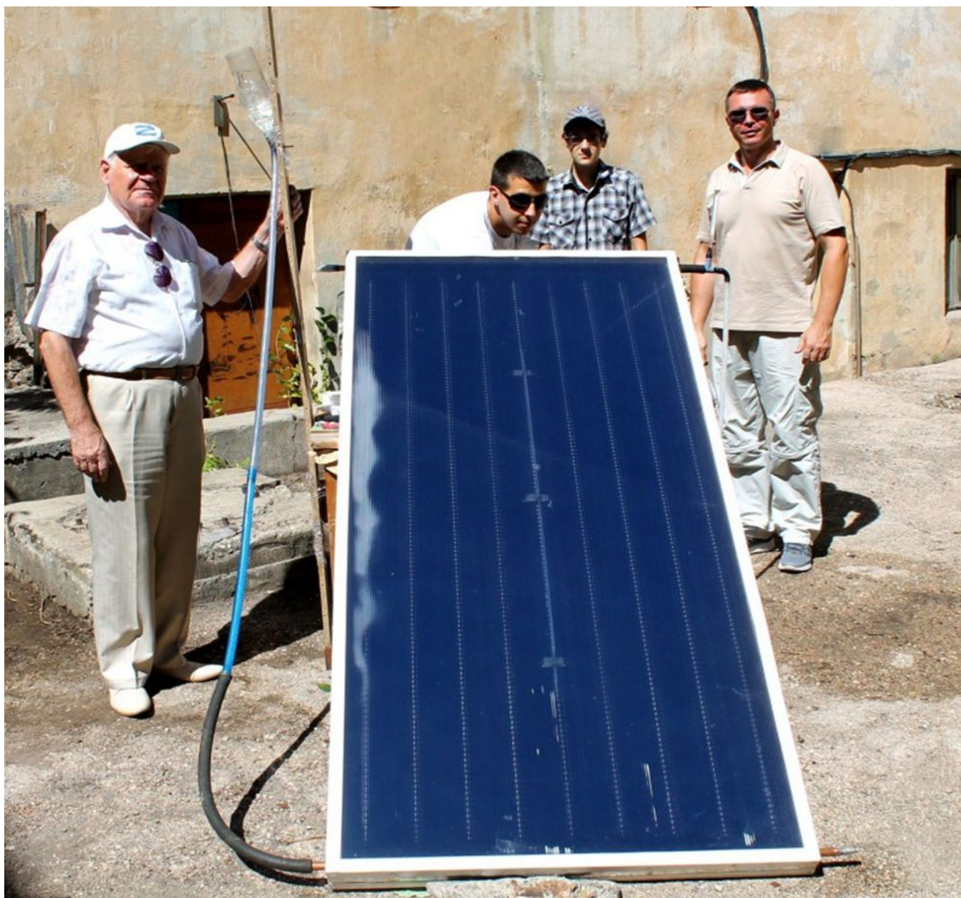
Испытания гелиоколлектора с селективным покрытием в Институте природно-технических систем
