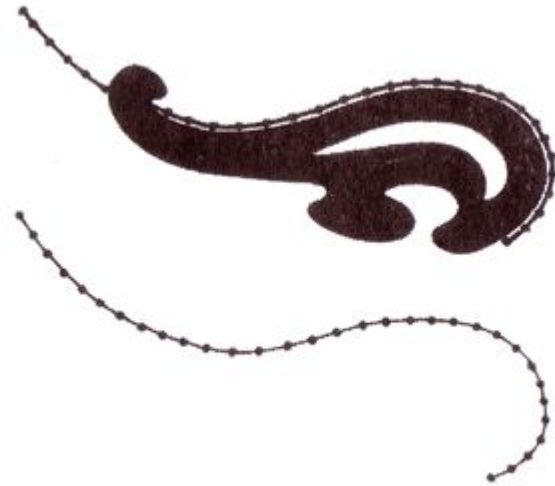
Рис. 20. Обводка кривых линий по лекалам
