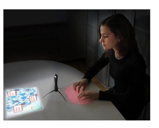
Один проектор играет роль монитора, второй проецирует виртуальную клавиатуру на стол. Все вычислительные процессы проводятся не на самом девайсе (уж слишком он мал), посредством обпачных сетей. Помимо этого мини компьютер способен выполнять роль мобильного телефона.
