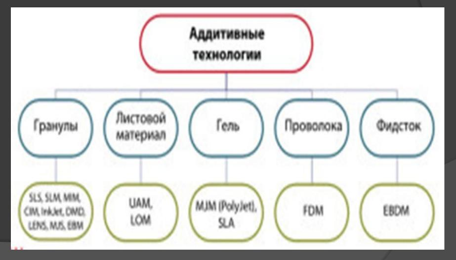
FDM (Fused deposition modeling) — послойное построение изделия из расплавленной пластиковой нити. Это самый распространенный способ 3D-печати. FDM-принтеры работают с различными типами пластиков, самым популярным и доступным из которых является
