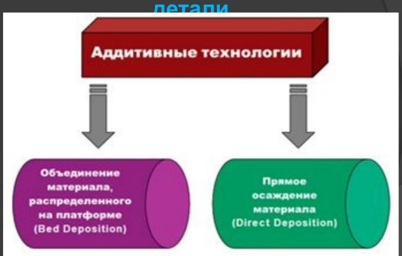
Первое направление - предусматривает формирование детали путем объединения материала, распределенного на рабочей поверхности платформы технологического оборудования (Bed deposition). Процессы объединения материала, распределенного на платформе, заложены в основу различных видов технологического оборудования для производства деталей методами аддитивных технологий:
