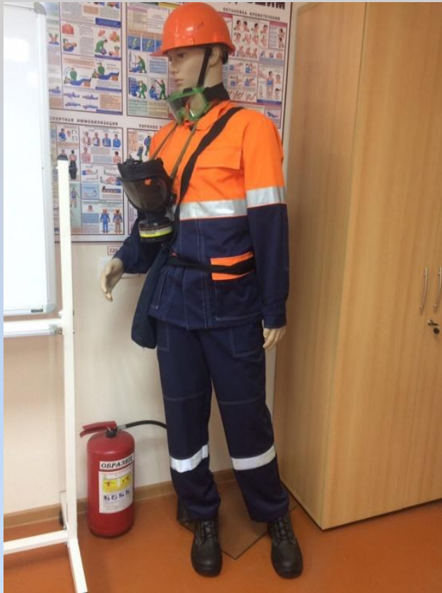
Промышленный противогаз ДОТ-460 (на углеводородный газ) с коробкой A2B2E2AX
