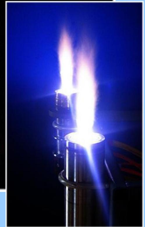
На экспериментальном воздушном корабле ДЦ-Э1 будут проведены первые эксперименты по нагреву несущего газа плазматронами. Для этого предварительно выбран многофункциональный портативный плазменный комплекс ГПЗ7-12 «Горыныч» отечественного производства. Этот комплекс отличается малыми габаритами и вполне достаточной для опытов мощностью.
