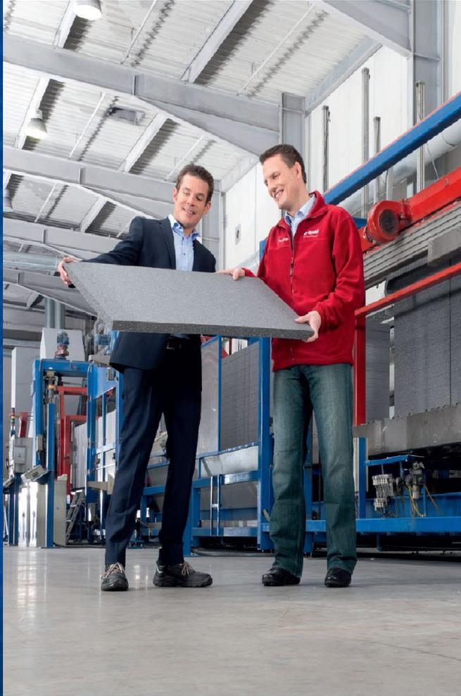
вспененный полистирол с частицами графита. За счет выделения и отражения инфракрасного излучения материал с графитовыми частицами может обеспечить теплопроводность на 20% меньше, чем обычный полистирольный пенопласт. За счет низкой теплопроводности можно до 50% уменьшить использование дорогостоящего сырья.
