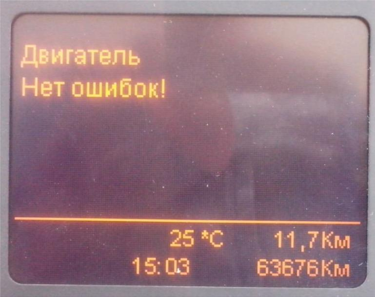
8. Отображается название подсистемы, общее количество ошибок в блоке, порядковый номер отображаемой ошибки, код параметра, по которому произошла ошибка и тип неисправности. Далее нажатиями на кнопки «ВНИЗ» и «ВВЕРХ» можно пролистать до 10 активных ошибок блока. Если ошибок больше чем 10, то следующие ошибки можно будет посмотреть только после устранения тех, которые уже отображены.
