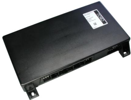
**ЦБУЭ** на базе **СВСУЗ-Е24L** (ContinentalAG) ЦБУЭ одно из базовых звеньев мультиплексной архитектуры электрооборудования, предназначенное для управления и контроля электрооборудованием автомобиля, выполняющее функции подготовки обработки данных для вывода на комбинацию приборов.
