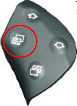
5. Кнопками «ВВЕРХ» или «ВНИЗ» выбираем пункт «Двигатель» либо ту систему, электронный блок управления которой нужно протестировать. Нажимаем кнопку «МЕНЮ»
