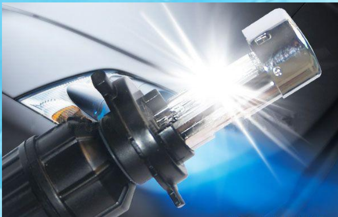
Дуговой электрический разряд в ксеноновой лампе
