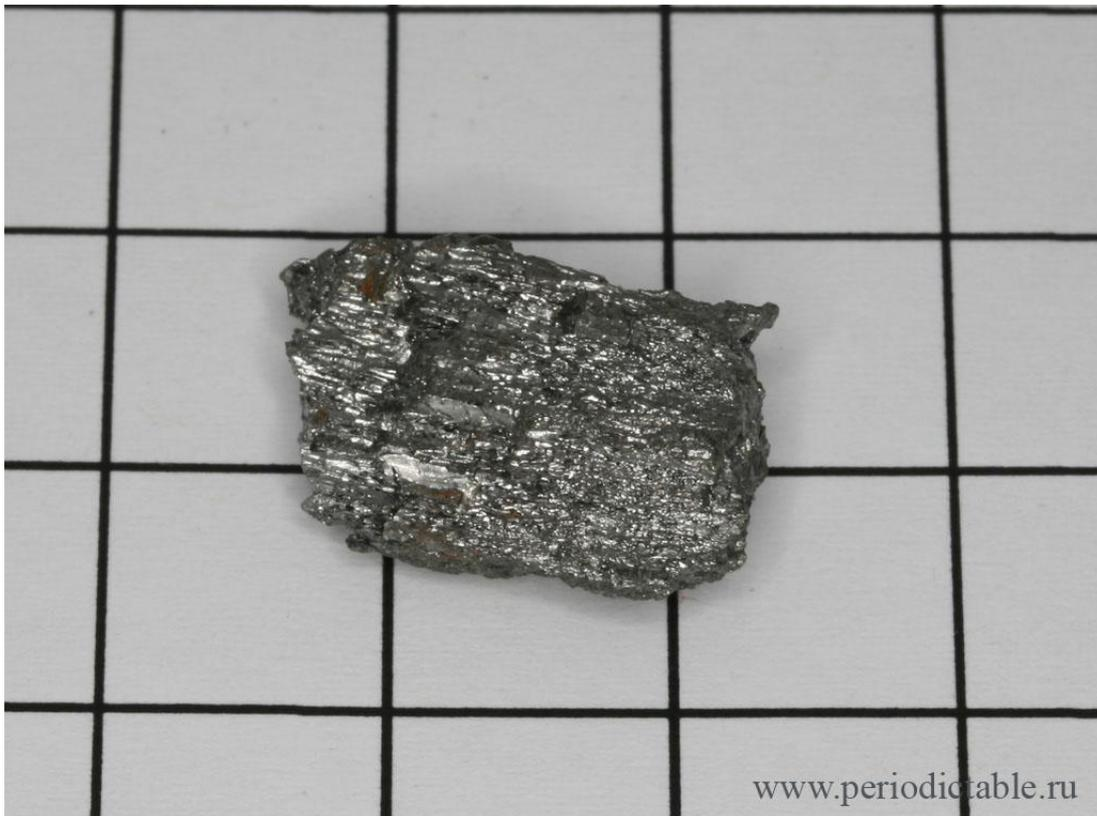
**Основное достоинство – низкое сечение захвата тепловых нейтронов, недостатки – крайне низкая пластичность и высокая токсичность.**
