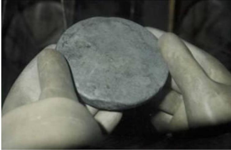
$\text{Pu}^{232\ 244}$  в природе почти не встречается, при облучении  $\text{U}^{238}$  в реакторе получают  $\text{Pu}^{239}$ . Хорошо очищенный плутоний является химически активным металлом (активнее урана) с никелевым блеском. На воздухе металл тускнеет.
