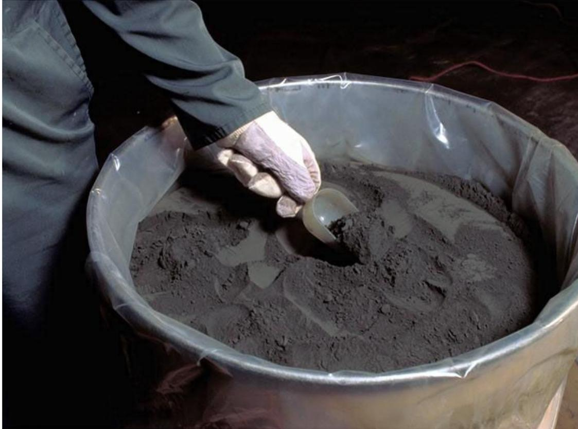
Всего 7 окислов, наиболее распространены  $\text{UO}_2$ ,  $\text{U}_4\text{O}_9$ ,  $\text{U}_3\text{O}_8$ ,  $\text{UO}_3$ . Используется первая, массовое содержание урана 88 %, на цвет темно серая (почти черная). В ядерной энергетике может быть использована в виде прессованных или спеченных изделий.
