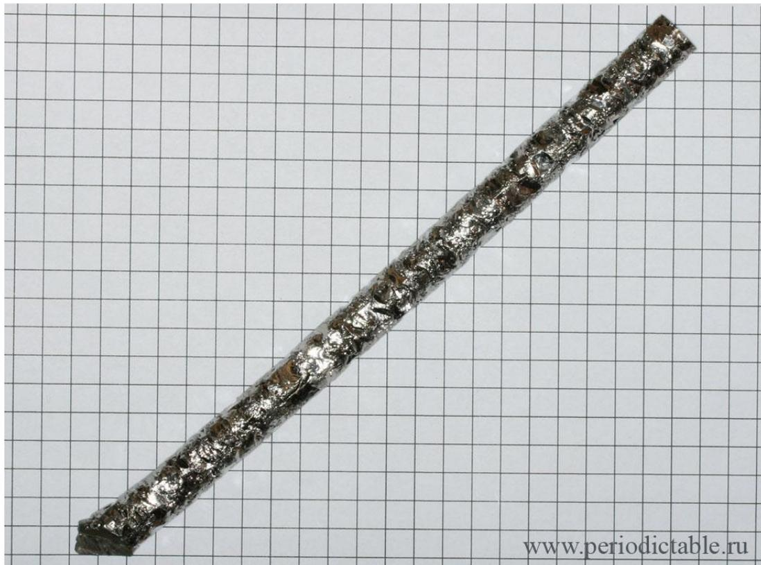
Наиболее широко распространенный материал в ядерных реакторах. Достоинства: низкое сечение поглощения тепловых нейтронов, высокая температура плавления. Сплавы циркония коррозионно стойки в воде и паре при  $350\div 360^{\circ}\text{C}$ . Для улучшения механических свойств легируется ниобием.
