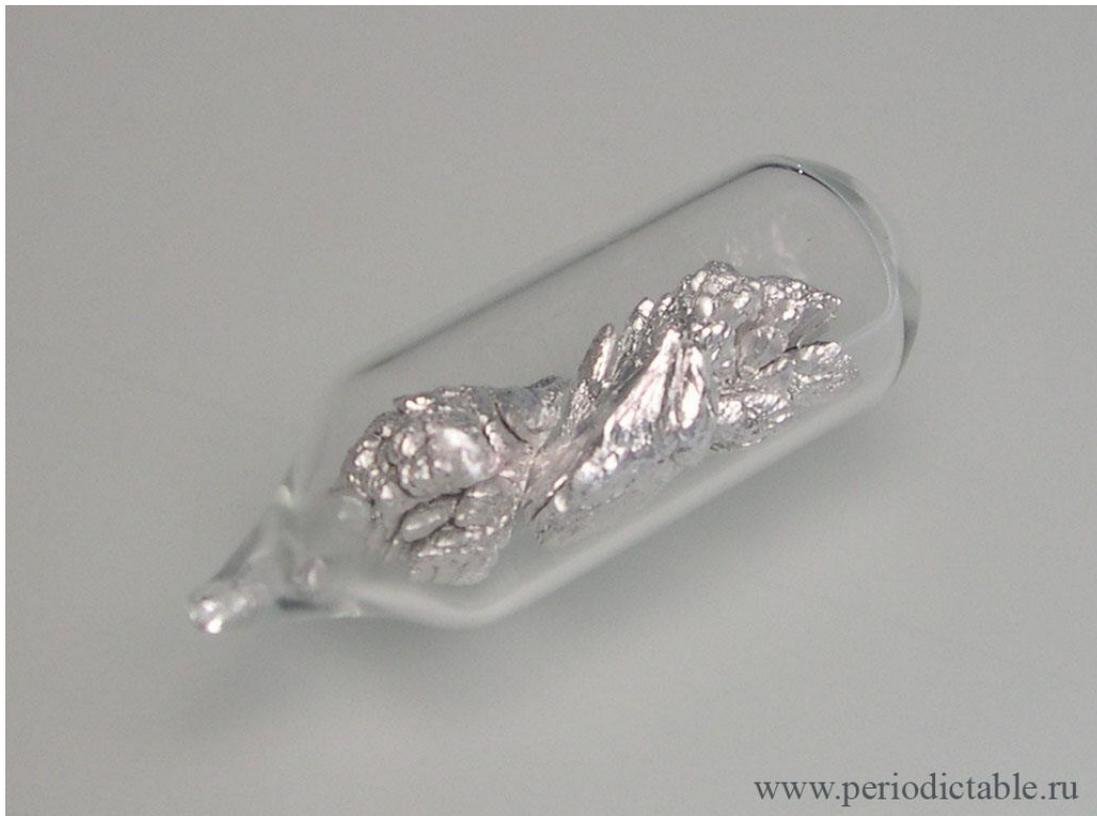
Применяется легированный цирконием, алюминием, торием, цинком, марганцем. Основное применение в сплаве magnox (0.5 ÷ 0.7 % Zr, 0.8 % Al) в английских и французских графитовых реакторах на углекислом газе при 330 ÷ 400°C.
