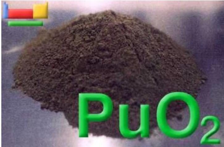
Известны  $\text{PuO}$ ,  $\text{Pu}_2\text{O}_3$ ,  $\text{PuO}_2$ . Применяется последняя (цвет желто – коричневый) в смеси с  $\text{UO}_2$  при массовом содержании плутония до 30%. Свойства оксида плутония зависят от метода и условий получения. Диоксид плутония гигроскопичен.
