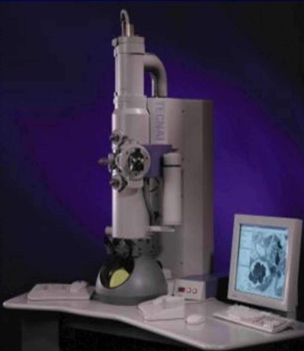
Прибор, в котором для получения увеличенного изображения используется электронный пучок. Разрешающая способность электронного микроскопа в сотни раз превышает разрешающую способность оптического микроскопа.
