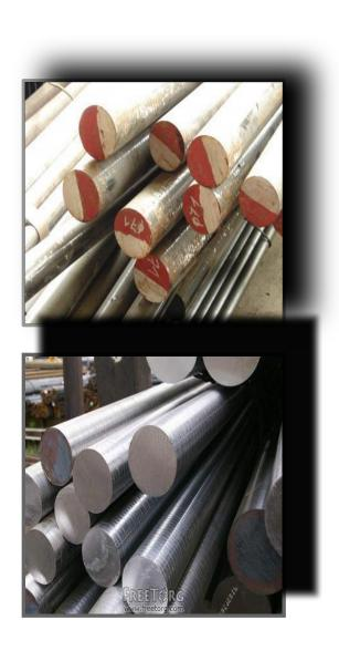
Нихром — общее название группы сплавов, состоящих, в зависимости от марки сплава, из 55—78 % никеля, 15—23 % хрома, с добавками марганца, кремния, железа, алюминия. Основными достоинствами нихромовых сплавов являются
