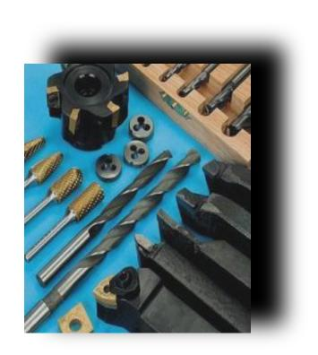
**Победит** — металлокерамический твердый сплав. Твёрдый сплав карбида вольфрама WC и кобальта Он по твердости близок к алмазу, применяется при бурении горных пород.
