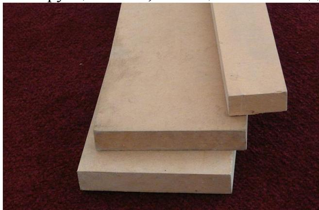
**МДФ (Medium Density Fiberboards)** – плиты сухого способа формования с равномерной по толщине плотностью 800 – 850 кг/м<sup>3</sup>. Они применяются в производстве мебели, декоративных стеновых панелей, облицованного паркета, тары.
