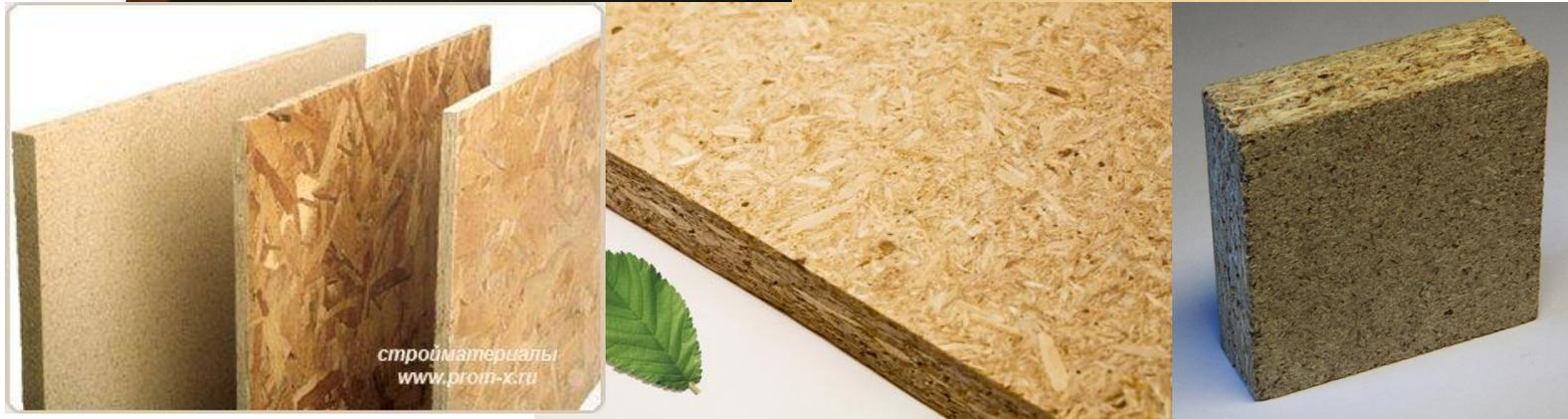
**Древесностружечные плиты (ДСтП)** – (wood particle boards) получают путем горячего прессования древесных частиц, смешанных со связующим.
