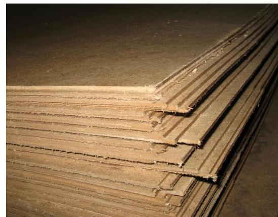
**Древесноволокнистые плиты (ДВП)** – (wood fiber boards). Это листовой материал, изготовленный в процессе горячего прессования и сушки, сформированный в виде ковра из древесноволокнистой массы. **ГОСТ 34026-2016 Плиты древесноволокнистые. Определение, классификация и условные обозначения**
