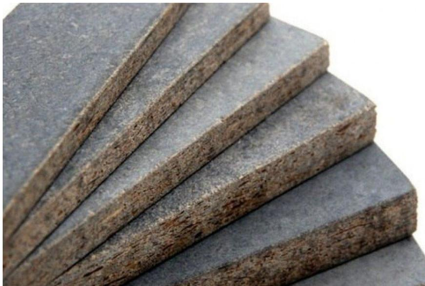
**Ксилолит.** Это строительный материал, состоящий из смеси опилок или древесной муки с магниезальным вяжущим. Используется в виде плиток для покрытия полов, отделки стен и других целей. Ксилолит – износостойкий, негорючий, водоупорный материал высокой прочности.
