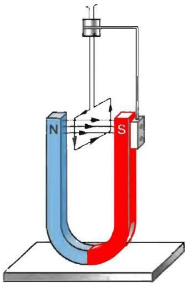
Если подвесить на гибких проводах рамку с током между полюсами магнита, то рамка будет поворачиваться до тех пор, пока плоскость её не установится перпендикулярно к линии, соединяющей полюсы магнита.
