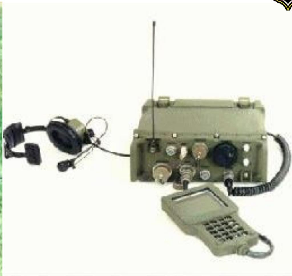
Рисунок 3.5 - Переносная станция радиоразведки AN/PRD-11
